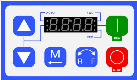
Figure 15 VFD 제어 패널
